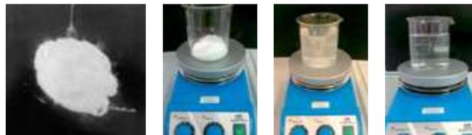
**CRYSTALSOP®** verifica di solubilità in acqua; max concentrazione possibile: 125 g/lit  $H_2O$  a 25°C.
